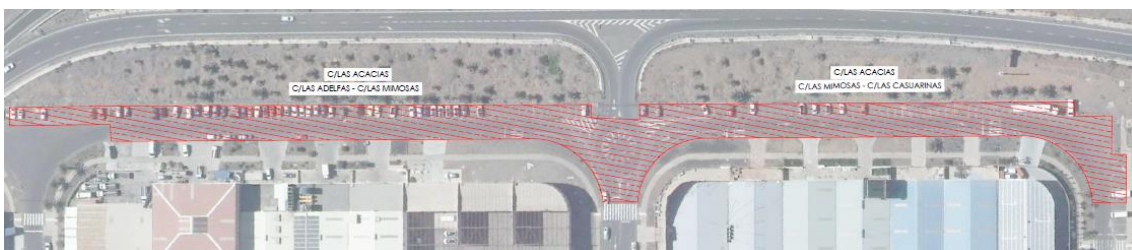
Zonas de actuación de fresado y asfaltado en la calle Las Acacias.
