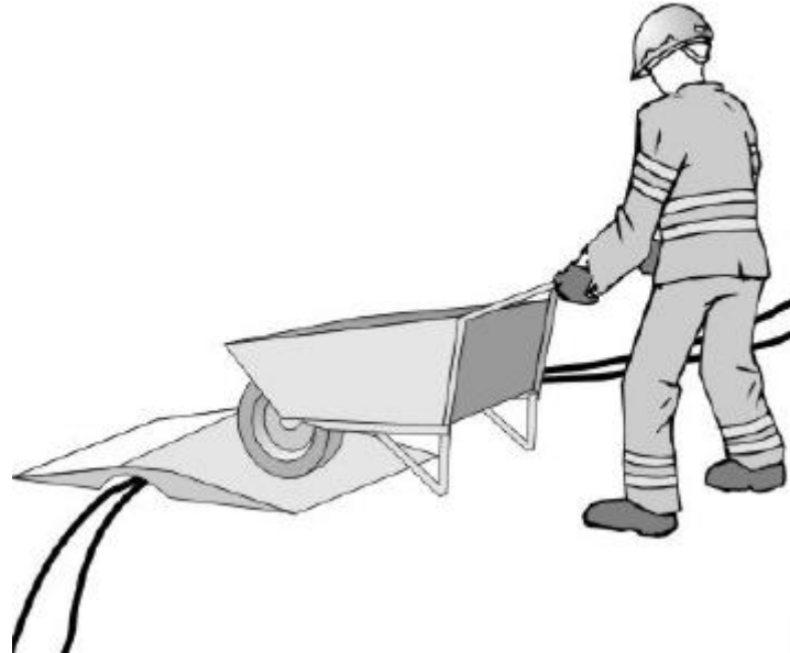
Protección de conductores.
