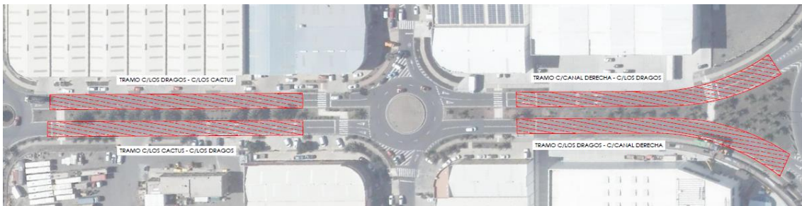
Zonas de actuación de fresado y asfaltado en la calle Los Algarrobos.
